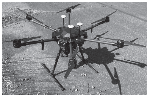
図6 ドローンをを用いた新たな電磁探査法開発に向けた実験の様子
