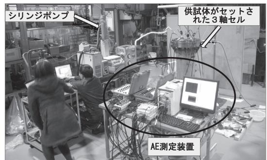
図21 SC-CO<sub>2</sub>による水圧破碎の室内実験風景
