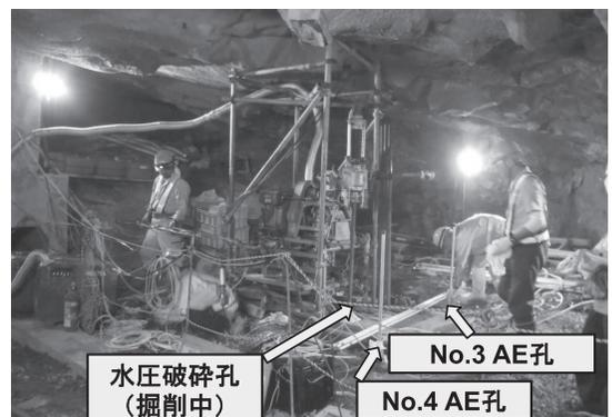
図25 SC-CO<sub>2</sub>による水圧破砕実験の現場風景
