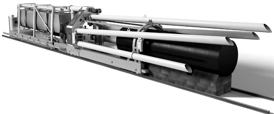
図5 スクリューフィーダ充填機 (Müller et al., 2017)
