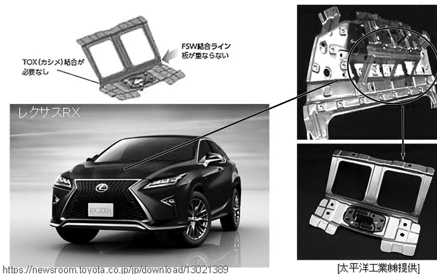
図7 FSWを使用したアルミ板材のテールードブランク
