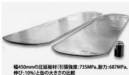
図17 新開発合金で得られたサンプルサイズと機械的特性
