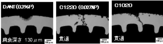
図 13 0.1 mass% ギ酸霧雰囲気暴露 80 日後の溝付管の断面観察結果<sup>6)</sup>
