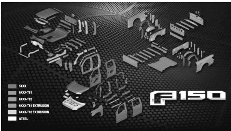
図1 フォード F150 のアップーボディ各部品の材質
