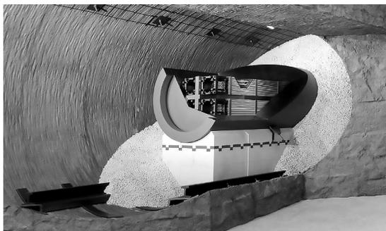
図1 スイスの高レベル放射性廃棄物処分コンセプトの実物大模型(グリムゼル試験場)
