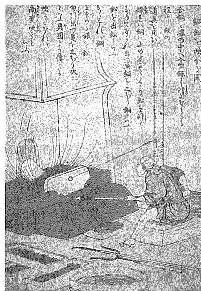
図1 銅鉱を吹分る図(南蛮吹き)
